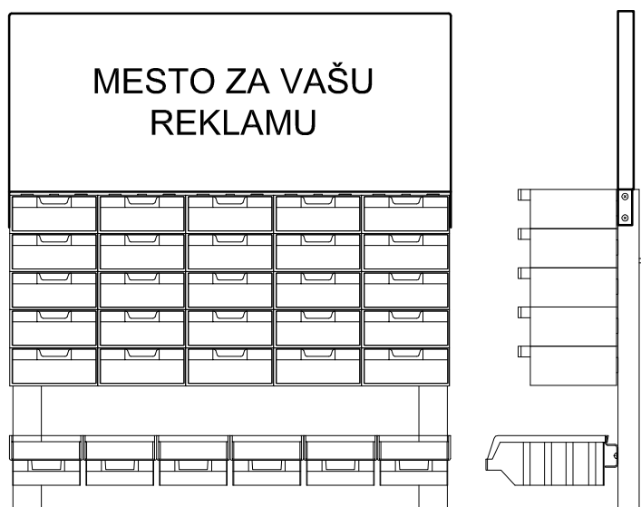
reklamni pano i stojeći nosač nakon montaže
